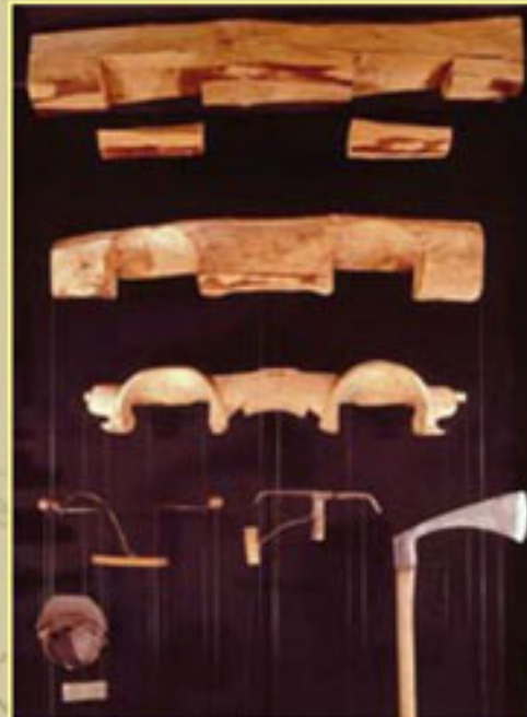
Séquence de fabrication d'un joug
